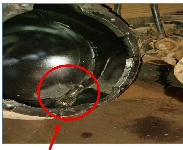
Imagem detalhada do local onde quebrou o semieixo e da ponta quebrada
