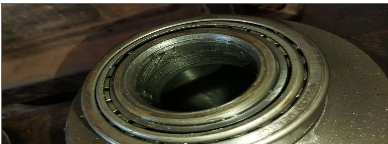
Imagem de rolamento do diferencial danificado
