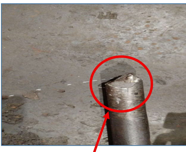
Imagem detalhada do local onde quebrou o semieixo e da ponta quebrada
