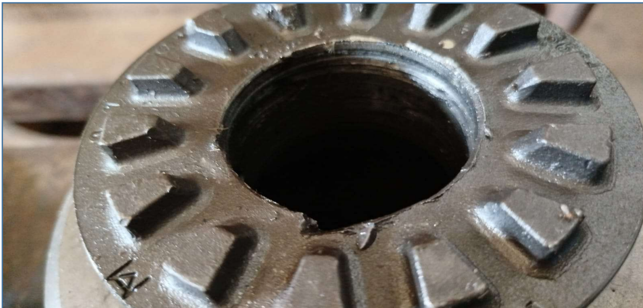
Imagem detalhada da porca da coroa danificada
