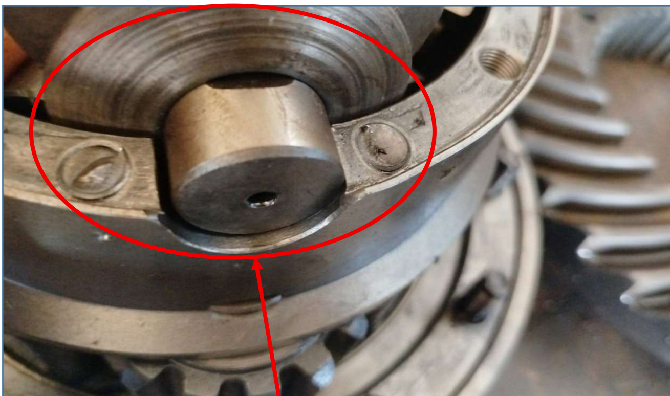
Imagem com sinais evidentes de desgaste do diferencial
