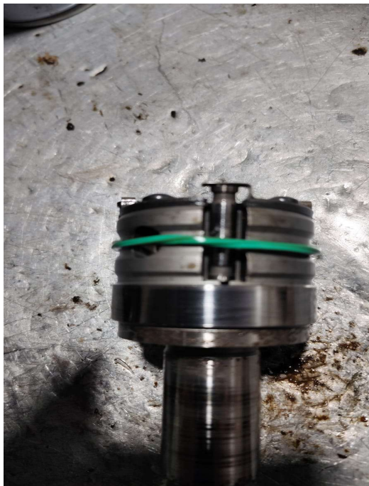
Conjunto rotor/cabeçote hidráulico da bomba injetora, desmontado para inspeção em bancada.
