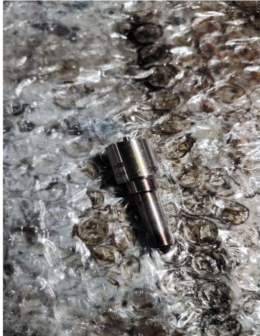
Detalhe da ponteira (bico) de um dos injetores, removida para verificação.
