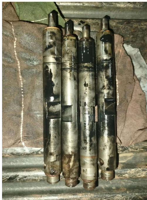
Conjunto dos quatro bicos injetores removidos do motor para avaliação.
