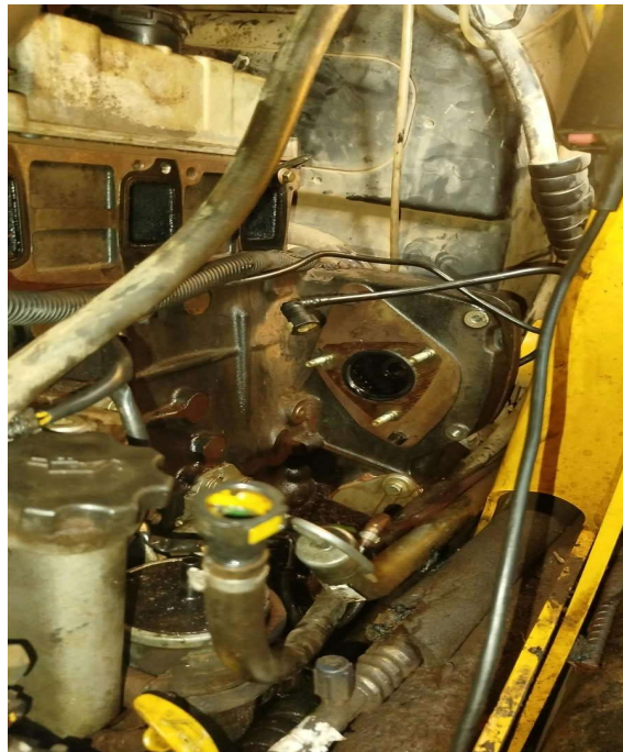
Detalhe do flange de fixação da bomba injetora no motor, após a remoção da bomba para avaliação.
