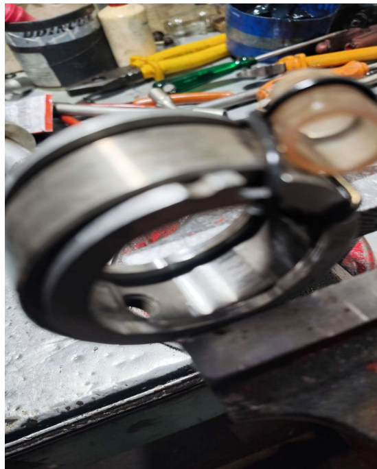
Detalhe do anel de cames com os roletes de acionamento dos êmbolos da bomba injetora.
