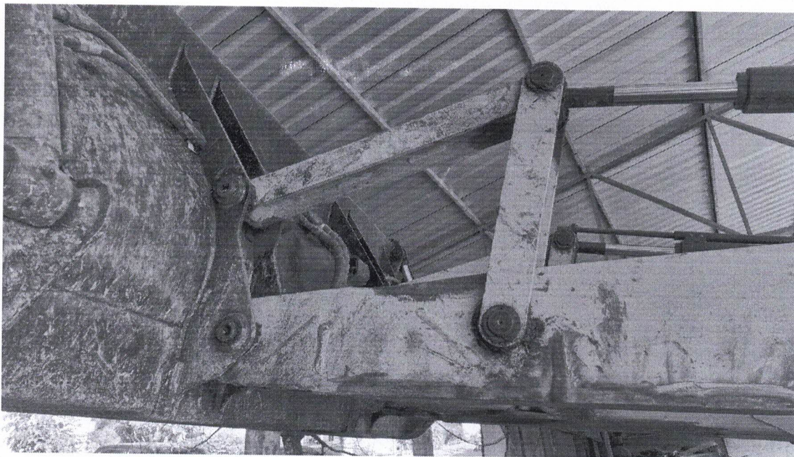
Detalhe das articulações do conjunto dianteiro e da concha frontal.
