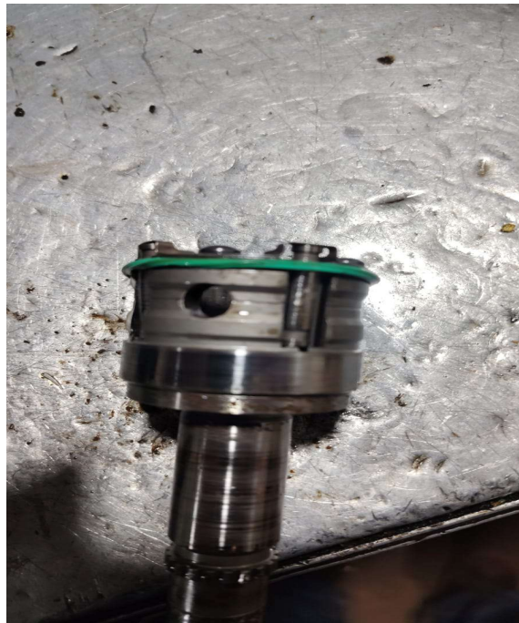
Outra vista do conjunto rotor/cabeçote hidráulico da bomba injetora.
