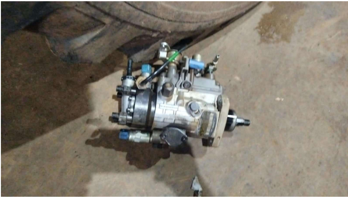
Bomba injetora rotativa já removida do motor, antes da desmontagem para avaliação.
