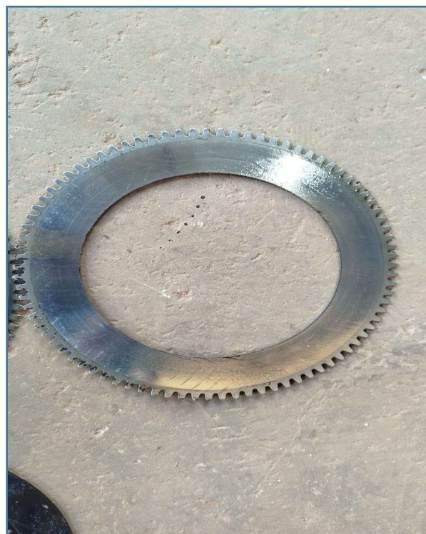
IMAGEM DE PLACA SEPARADORA RETIRADA, TERÃO QUE SER SUBSTITUÍDAS
