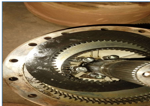
IMAGENS DO CONJUNTO DO TANDEM JÁ DESMONTADO
