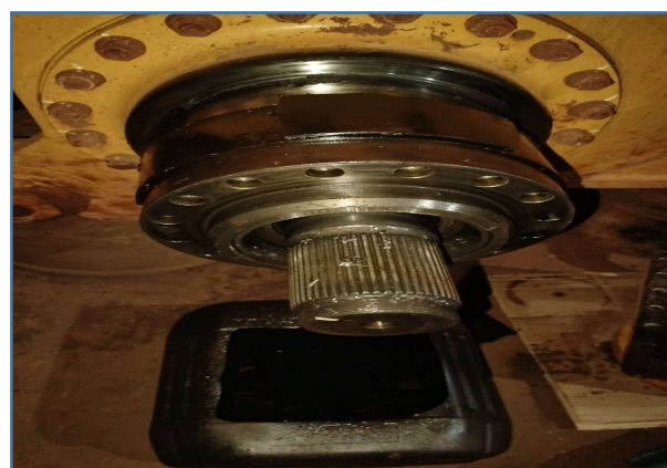
IMAGENS DO CONJUNTO DO TANDEM JÁ DESMONTADO
