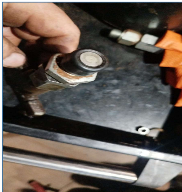
IMAGENS DA VÁLVULA DO FREIO ESTACIONÁRIO QUE ESTÁ DANIFICADA
