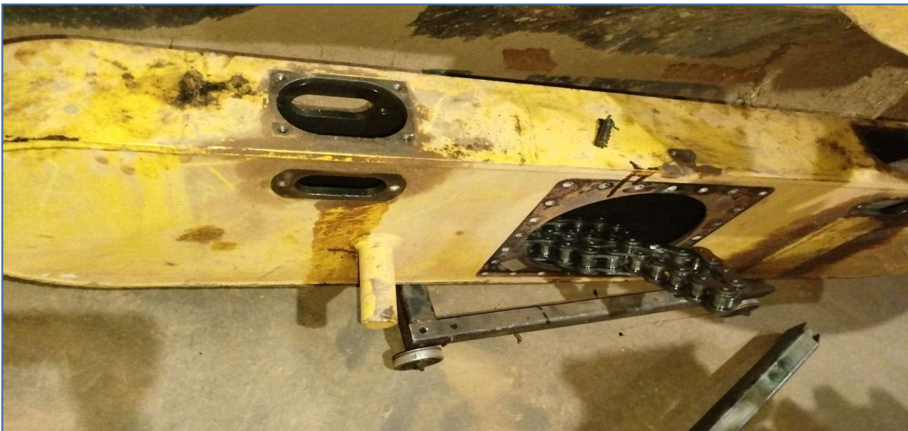
IMAGEM DE TANDEM E CORRENTE DA MOTONIVELADORA DESMONTADOS
