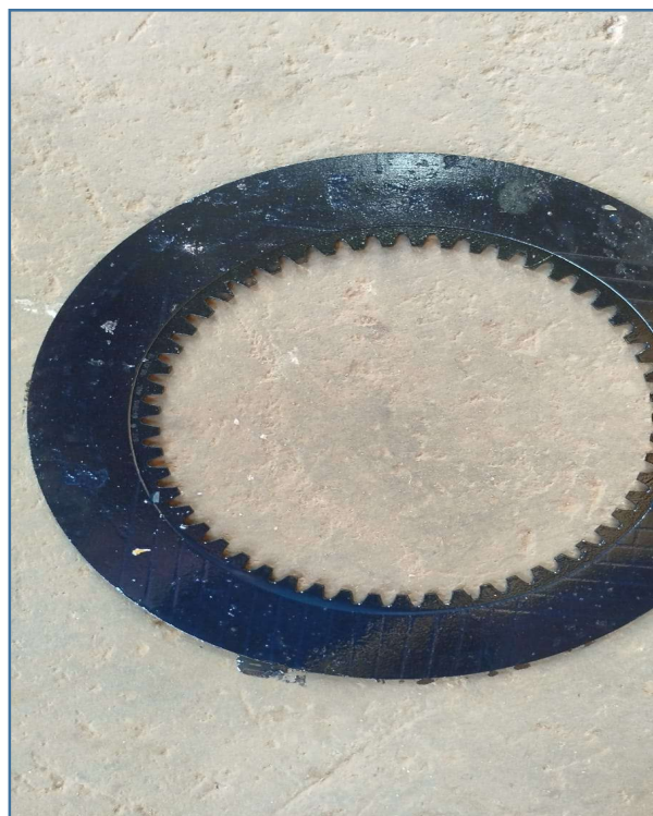
IMAGEM DE DISCO RETIRADO, TERÃO QUE SER SUBSTITUÍDOS
