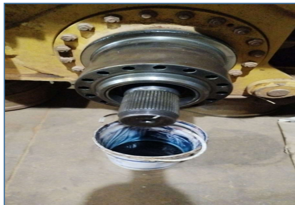
IMAGENS DO CONJUNTO DO TANDEM JÁ DESMONTADO
