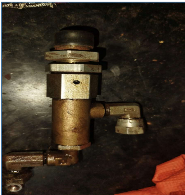
IMAGENS DA VÁLVULA DO FREIO ESTACIONÁRIO QUE ESTÁ DANIFICADA
